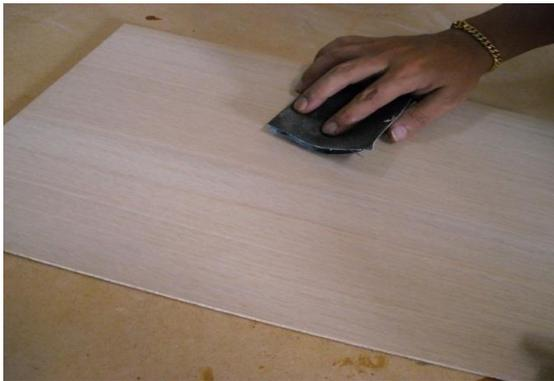
從 80 號至 100 號、120 號砂紙依序磨光，若木料表面細緻度夠，從 80 號砂紙開始即可。若希望成品表面光澤較佳，可使用較高號數的砂紙，但不建議超過 240 號以上。
